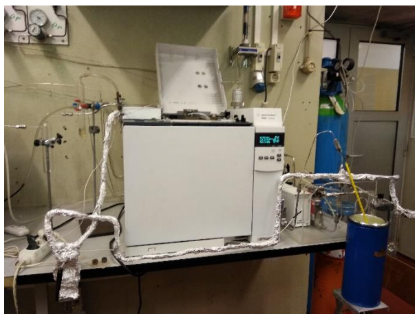
Figura 16 - Montagem experimental para a reação de desidrogenação / desidratação do 2-propanol.
