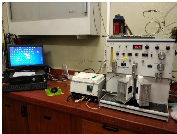
Figura 9 - Aparelho de medição das áreas superficiais Micromeritics Chemisorb 2720.
