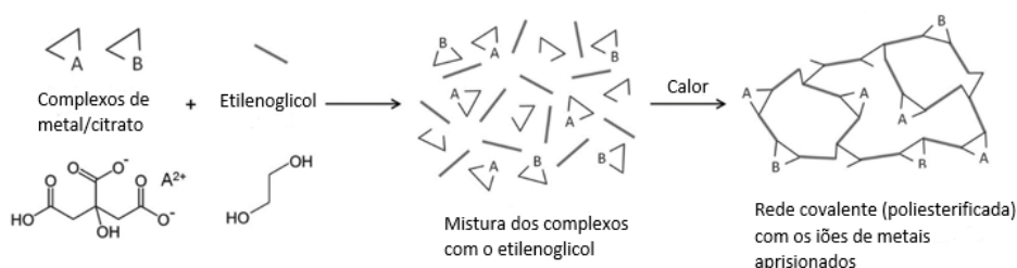
Figura 4 - Esquema do método de Pechini para formar géis organometálicos (adaptado de [57]).
